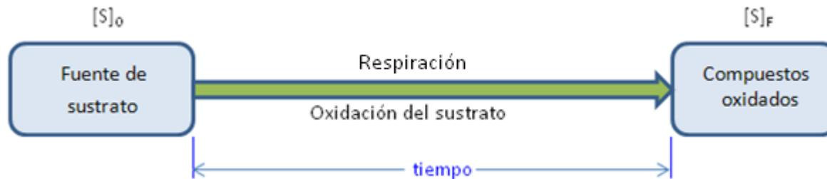
Al realizar el ensayo de respirometría con los soportes o biomasa granular en el interior del reactor, esta velocidad ( $r_p$ ) se referiría exclusivamente al número de soportes o concentración de gránulos incluidos en este paquete (P) por litro.
