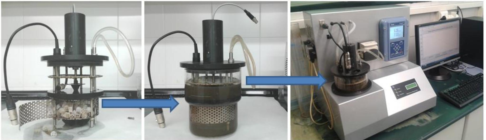
Carga de soportes en reactor del respirómetro
