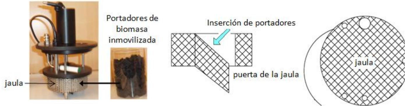
El modo de trabajo consistiría en cargar los portadores en la jaula del reactor, cerrar la jaula e instalar el reactor en el sistema de respirometría.
