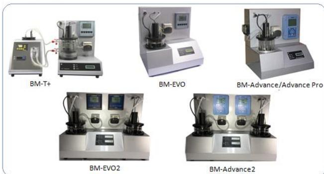
El BM-T+ va provisto de un sistema de atemperación externo y los EVO y Advance llevan incluido un sistema sólido (peltier & calefactor) en el propio analizador.
