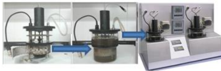
Carga de portadores de biomasa en el reactor biomass-carrier
