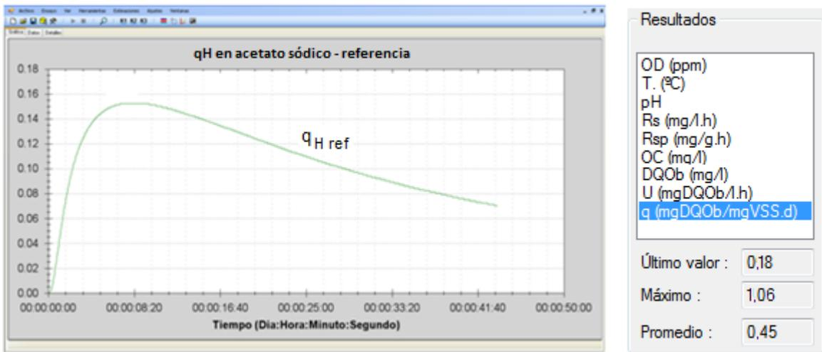
Respirograma y resultados del valor de la q en ensayo R del acetato sódico
