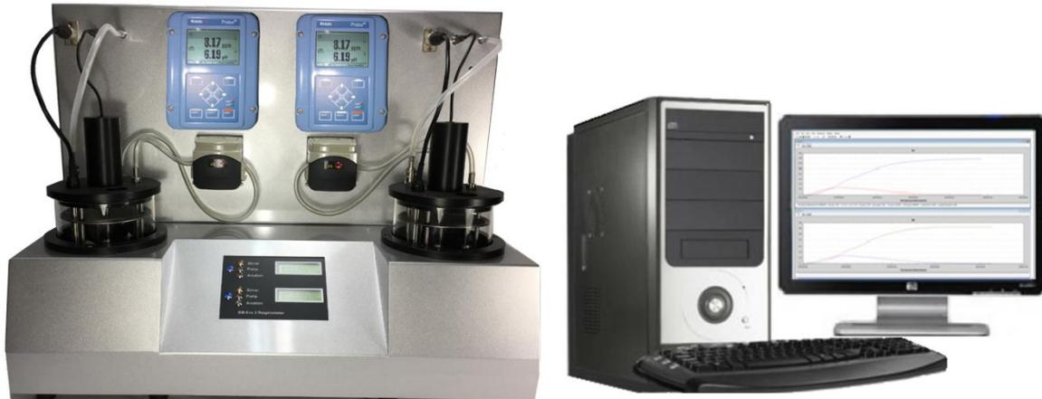
El sistema de dos reactores permite un sustancial ahorro de tiempo gracias a la posibilidad de ejecución de dos ensayos de forma simultánea en idénticas o distintas condiciones de pH, Oxígeno, Temperatura y Volúmenes de muestra.
